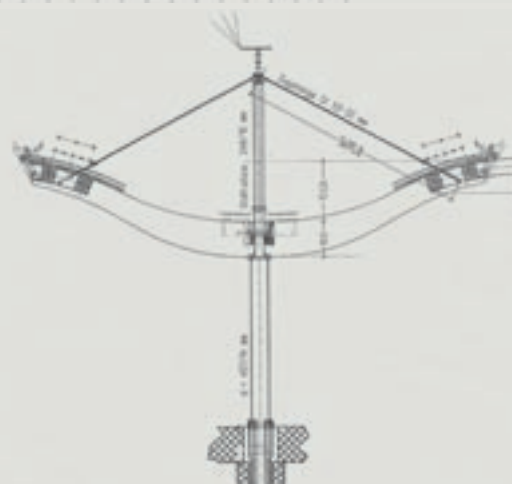
1 L'intervento nel suo complesso. 2 Prospetti del III° Lotto. 3 Sezioni trasversali palazzina Uffici. 4 Struttura di copertura in legno lamellare incollato e acciaio.
