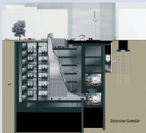
Le stazioni Gondar ed Annibaliano sono realizzate con scavo tra paratie utilizzando la tecnica Top-Down.
